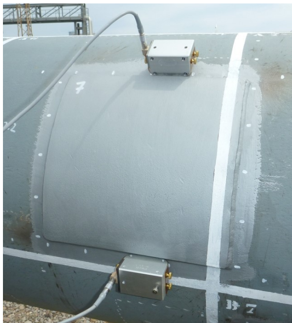
Figura 4. Sensores de transmisión y recepción posicionados a ambos lados de un refuerzo.
